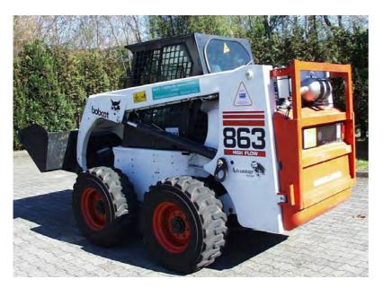
Seitenansicht des Bobcat 863 mit GfA-DPF/KAT-Anlage mit Additivunterstützter Regeneration.
