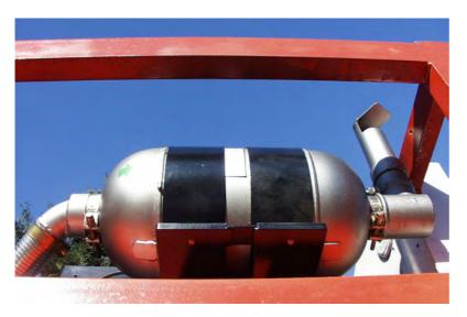
Hier kann man noch mal die Grundplatte von unten sehen, sowie das beliebig einzustellende Abgasendrohr mit Schutzdach – komplett aus Edelstahl.
