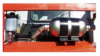
Hier wird der Rußfilter mit Grundplatte und 2 Halteschellen gezeigt, sowie der (noch) unisolierte Flexschlauch des Abgaseintritts. Links im Bild der Behälter (2,5 Liter) Additiv KAT-2000 mit Dosierpumpe. Der Füllstand ist leicht zu erkennen, wird außerdem nochmals angezeigt durch eine rote Lampe "Check-Additiv" am Kontrollgerät in der Fahrerkabine.
