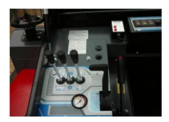
Die Drucküberwachung sowie Manometer werden gut sichtbar im Führerhaus angebracht.
