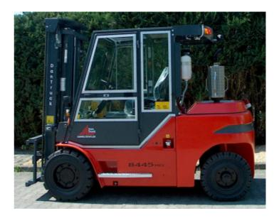
Der GfA-Dieselpartikelfilter wird anstelle des Originalschalldämpfers auf das Kontergewicht geschraubt.
