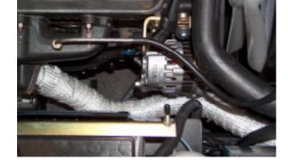
Das Original-Abgasrohr muss ausgebaut und gut isoliert werden. Danach wieder entsprechend einsetzen.
