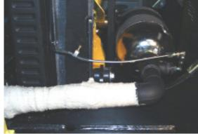
Anschluss für KAT-2000 wird mit einem T-Stück in die Kraftstoff-Leitung zwischen Kraftstoff-Filter und Pumpe installiert.
