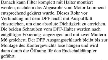
Achtung: bei Montage des Kontergewichts ist darauf zu achten, dass dieses Flexrohr nicht gequetscht wird und lose in der Öffnung zum Abgasendrohr liegt.
