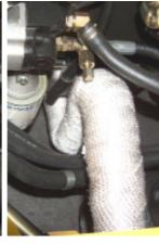
Isolation des Rohrs vom Krümmer bis zum Filtereingang
