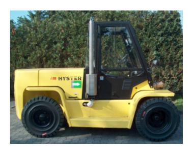
Der GfA-Dieselpartikelfilter wird anstelle des Original-Schalldämpfers mittels einer, im Lieferumfang enthaltenen, Halterung befestigt. Die Schrauben der Halterung werden in vorhandene Bohrlöcher geschraubt.
