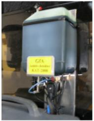
Die 2,5 Liter-Dosiereinrichtung wird hinter der Fahrerkabine, mit Hilfe eines Spezial-Halteblechs, angebracht. Zum Schutz des Behälters bzw. der Kabel, wird ein Schutzblech montiert.
