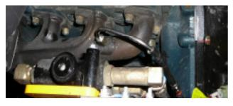
Der Abgriff für die Messung des Abgasgegendrucks befindet sich direkt am Krümmer. Dazu muss ein 1/8"-Gewinde geschnitten werden.
