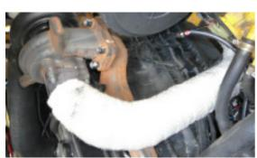
Der Dieselpartikelfilter wird dem Original-Schalldämpfer nachgebaut und mit Hilfe von im Lieferumfang enthaltenen Schellen im Motorraum eingebaut.
