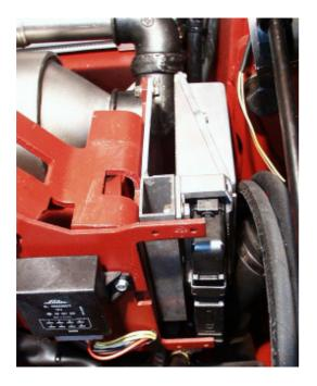
Bei dieser Abb. ist das Steuergerät mit von GfA beigestellter Halterung zu erkennen.
