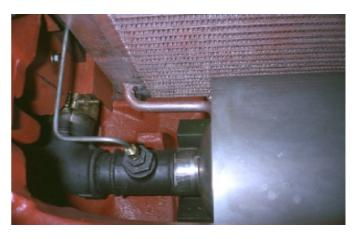
Abgasgegendruckröhrchen zur Drucküberwachung. Für Messungen vor dem DPF wird der Revisionsstopfen nach Lösen des Abgasgegendruckanschlusses herausgeschraubt.
