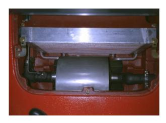
Der Filter liegt auf einer Halterung und wird mit einem Bügel und Originalschraube befestigt. Ein Blech schützt den Filter vor Kühlluft.
