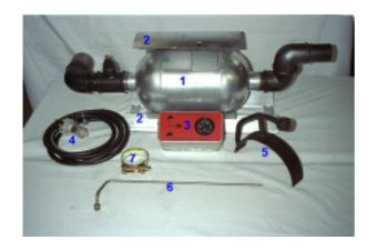
Original-Schalldämpfer ausbauen. Den Halter Pos. 2 lose ins Kontergewicht legen. Dann Filter darauf legen und mit dem Halter Pos 5 zusammen mit dem Luftleitblech befestigen, nachdem vorher die Verbindung zwischen Abgaskrümmer und DPF hergestellt wurde.
