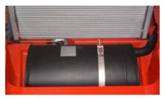
Der Dieselpartikelfilter wird in den Originalschalldämpfer integriert. Somit können alle Originalteile verwendet werden.
