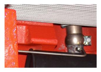
Der Abgriff für die Messung des Abgasgegendrucks befindet sich direkt am Krümmer. Dazu muss ein 1/8"-Gewinde geschnitten werden.
