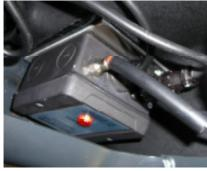
Das Steuergerät wird unter der Batterie im Motorraum angebracht, mit Hilfe einer Halteplatte.
