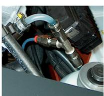
Das Rückschlagventil wird an Kraftstoffleitung angeschlossen.
