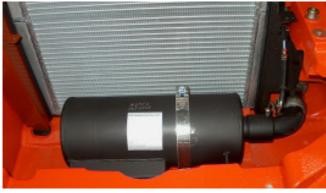
Der Dieselpartikelfilter wird anstelle des Original-Schalldämpfers mit Hilfe einer vorhandenen Schelle eingebaut.
