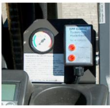
Die Drucküberwachungseinheit sowie das Manometer werden gut sichtbar im Führerhaus angebracht.
