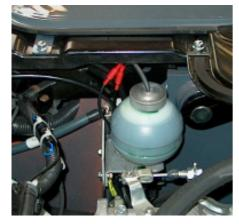
Die Dosiereinrichtung wird mit Hilfe einer Halterung im Motorraum befestigt.
