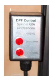
Die Drucküberwachung wird gut sichtbar im Führerhaus angebracht.
