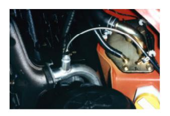
Die Muffe des Abgasgegendruckröhrchens wird auf ein vorgebohrtes Ø 18mm Loch an das Krümmerrohr geschweißt.
