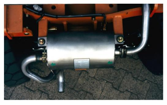
Der Dieselpartikelfilter wird in den Original-Schalldämpfer integriert Und kann mit den Original-Anschlüssen des Abgaseintrittsrohrs und Abgasaustrittsrohrs verschraubt werden.
