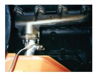
Die Muffe des Abgasgegendruckröhrchens wird auf ein vorgebohrtes Ø 18mm Loch an das Krümmerrohr geschweißt.
