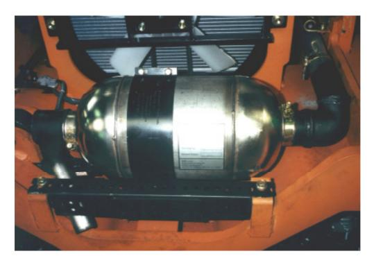
Der Dieselpartikelfilter wird anstelle des Original-Schalldämpfers eingebaut.
